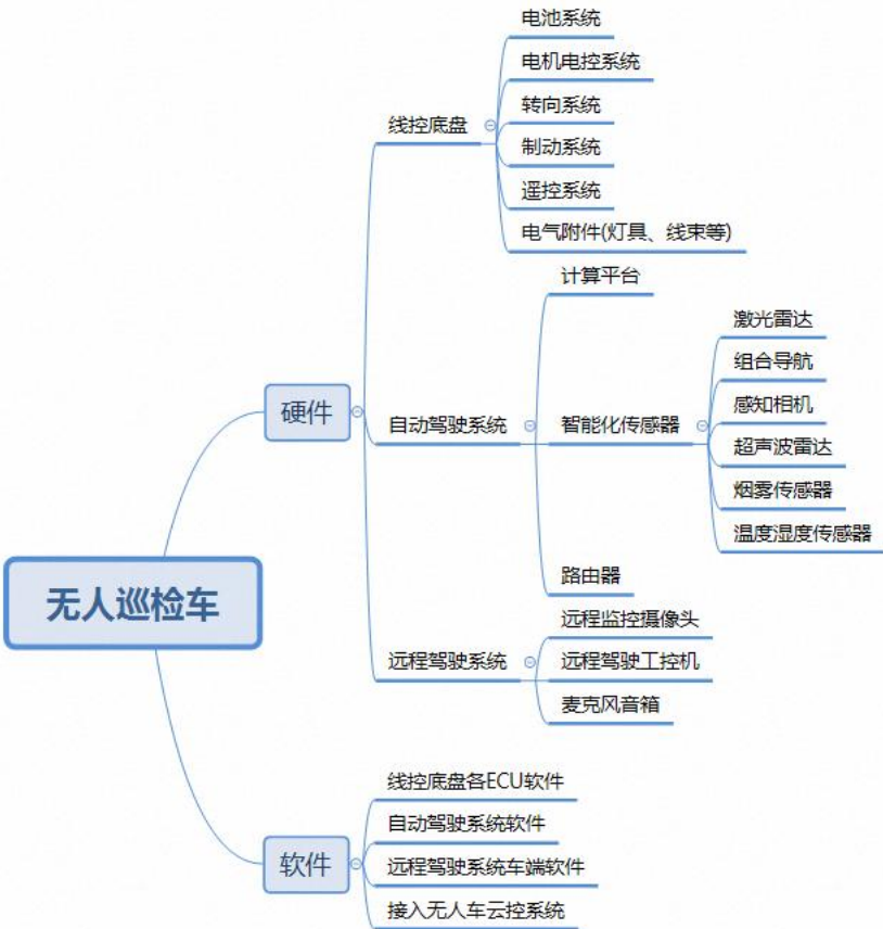
无人巡检车系统架构示意图
