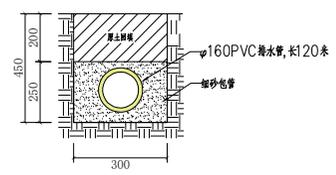
排水管安装断面图 1:100
