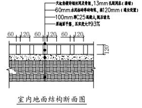
室内地面结构断面图
