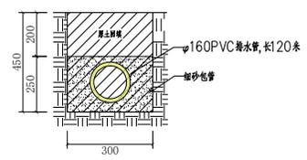
排水管安装断面图 1:100
