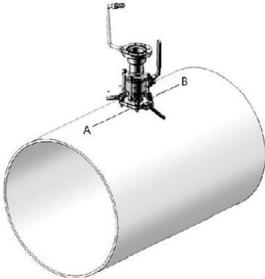
2) 根据管道外径，计算钢带的长度，用角磨机切割多余的钢带，然后用 8 颗 M6\*12L 内六角螺丝将钢带压板和钢带固定座固定在钢带两端，使用 5 号内六角扳手紧固。
