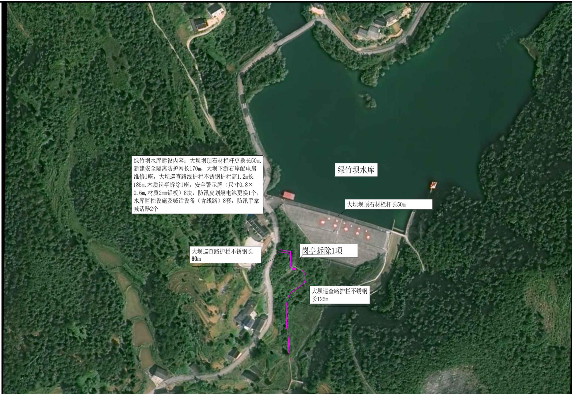
绿竹坝水库建设内容：大坝坝顶石材栏杆更换长50m，新建安全隔离防护网长170m，大坝下游右岸配电房维修1座，大坝巡查路线护栏不锈钢护栏高1.2m长185m，木质岗亭拆除1座，安全警示牌（尺寸0.8×0.6m，材质2mm铝板）8块，防汛皮划艇电池更换1个，水库监控设施及喊话设备（含线路）8套，防汛手拿喊话器2个
