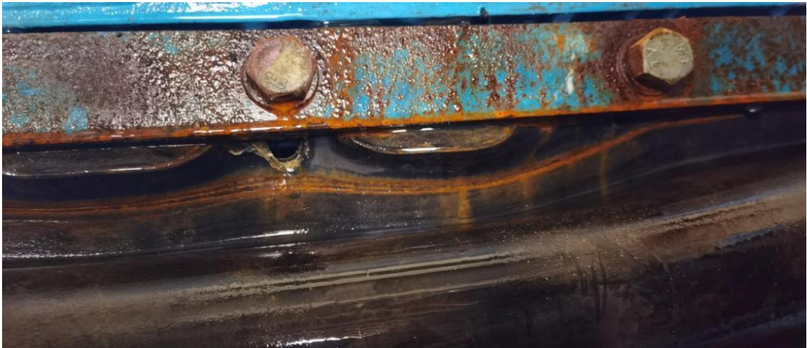
图 8 U 型密封框上部 C 型水封示意图
