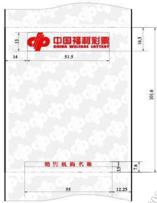
图 1 固定长度票面正面版式要求示意图(单位: mm)
